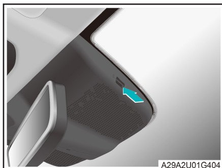
Puerto USB en el espejo retrovisor interior
