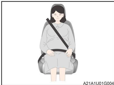
El uso adecuado del cinturón de seguridad por parte de las mujeres embarazadas puede reducir eficazmente las lesiones tanto de la embarazada como del feto en caso de colisión o frenado brusco.
