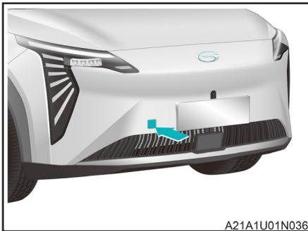
1. Abra la cubierta de remolque.
