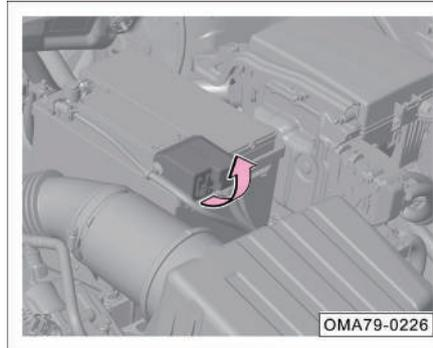
1. Abra la tapa del compartimento delantero del motor y levante la tapa del positivo de la batería en la dirección de la -flecha-.
