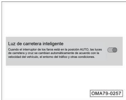
1. Cuando la alimentación del vehículo está en la posición "ON", a través del sistema de audio "Configuración → Accesorios de carrocería → Luces exteriores → Luz de carretera inteligente", haga clic en el botón programable
