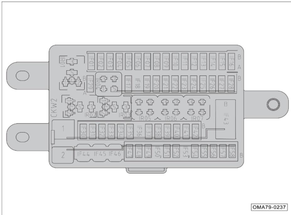
Fusibles en la caja eléctrica del tablero de instrumentos
