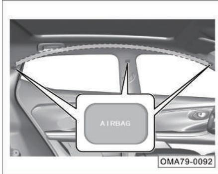
El airbag lateral de tipo de cortina está montado en el interior de la parte izquierda y derecha del techo (parte sombreado por línea de puntos), y "AIRBAG" es el símbolo del airbag.
