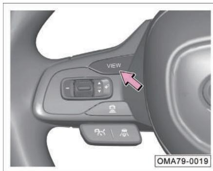
Con la alimentación del vehículo en la posición "ON", presione brevemente el botón "VIEW" en el lado izquierdo del volante para cambiar el tema del instrumento.
