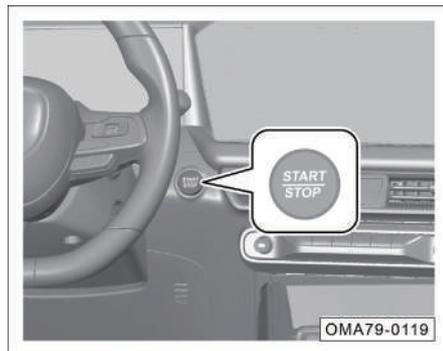
Se puede operar el interruptor de arranque (el botón START STOP) solo cuando se detecta la llave de control a distancia inteligente dentro del vehículo.
