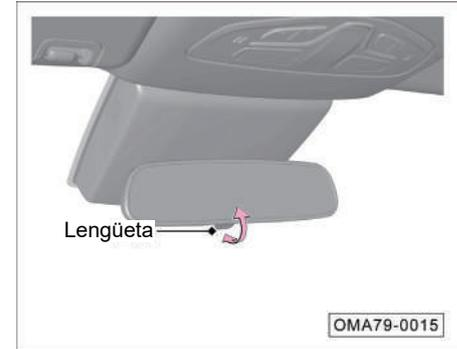
El ajuste manual del espejo retrovisor interior puede reducir el reflejo de la parte trasera, y hacer que la visión trasera esté en el mejor estado de observación.
