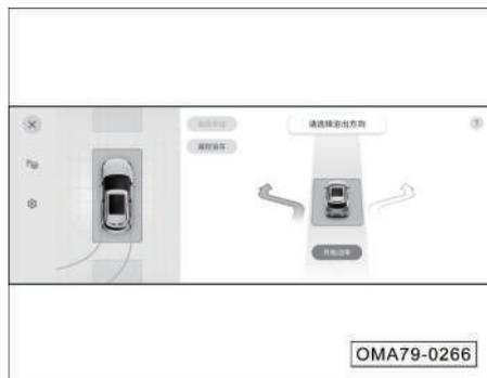
La función de salida de aparcamiento automático solo se puede activar en el espacio de estacionamiento en paralelo después de que el vehículo esté parado y cambie a la marcha P.
