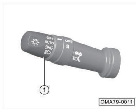
Cuando la alimentación del vehículo está en la posición "ON", al girar el interruptor de la luz ① se puede controlar para encender o apagar AUTO (luz automática) \*, ☽☾ (luz de posición), ☹ (luz de cruce).
