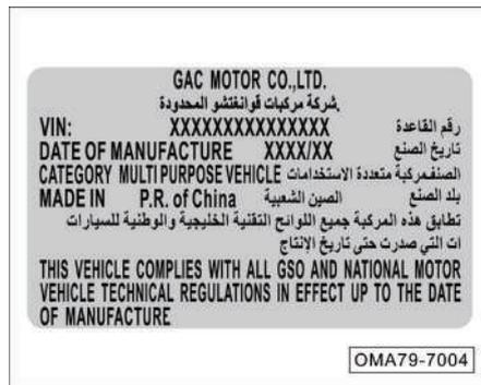
La etiqueta de la placa de identificación del vehículo está ubicada en el pilar B del lado del conductor.
