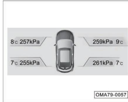
Cuando la alimentación de vehículo está en la posición "ON", gire hacia arriba/abajo el botón "OK" situado en el lado izquierdo del volante para ver el estado del vehículo.
