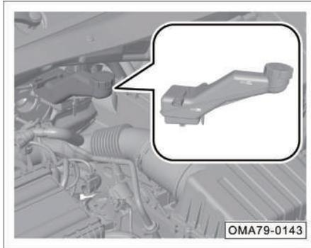
Después de que el motor se haya enfriado, compruebe que el nivel del líquido de frenos esté entre la marca de límite superior "MAX" y la marca de límite inferior "MIN".
