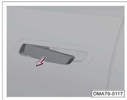
Cuando todo el vehículo está desbloqueado, la manija de puerta eléctrica oculta se despliega automáticamente y la puerta se puede abrir tirando de la manija de puerta.
