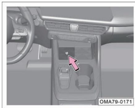
El área efectiva de carga inalámbrica se encuentra en la ranura de almacenamiento frente a la palanca de cambios. Al cargar, alinee la bobina de carga del teléfono móvil con la marca "Qi" para garantizar la carga normal del teléfono móvil.
