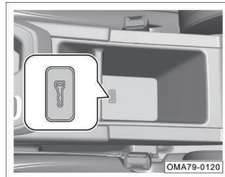
Si la batería de la llave de control a distancia inteligente está baja y la pantalla del instrumento combinado muestra "no se detectó ninguna llave", puede colocar la llave de control a distancia inteligente horizontalmente en la marca de llave en la parte inferior de la caja de reposabrazos central delantero, luego presione el interruptor de arranque para cambiar a la posición "ACC" u "ON", o pise el pedal del freno, presione el interruptor de arranque para encender el motor.
