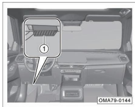
La interfaz OBD ① para leer el VIN electrónico se encuentra en la parte inferior izquierda del panel de instrumentos. Los datos como el VIN electrónico y la información del estado del vehículo se pueden leer a través de un equipo de diagnóstico especial.
