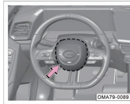
El airbag frontal del conductor está montado en el interior del volante (zona sombreada con línea discontinua) con el símbolo "AIRBAG".
