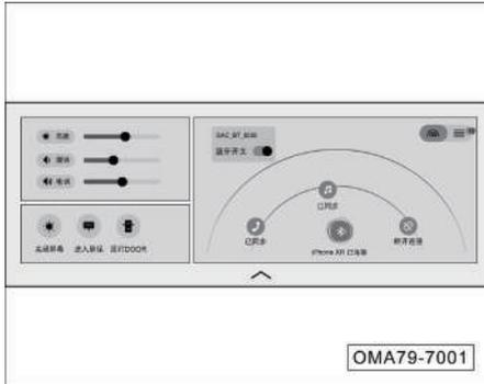
Después de la conexión Bluetooth, el ícono de la barra de estado se resalta y el nombre del dispositivo Bluetooth conectado se muestra en la interfaz de conexión Bluetooth:
