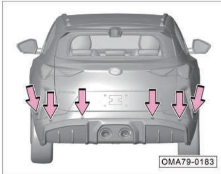
El sensor de radar está montado en la cubierta del parachoques trasero (para los modelos de radar delantero y trasero).
