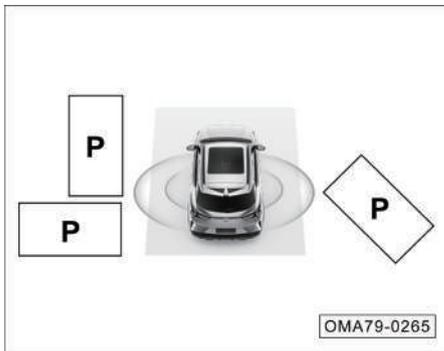
Mantenga el vehículo a menos de 0,5~2m de la plaza de aparcamiento en el lateral y mantenga su velocidad a no más de 25km/h. El sistema de estacionamiento de fusión realizará automáticamente una búsqueda de plaza de aparcamiento.
