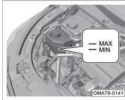
Compruebe que el nivel de refrigerante en el tanque de expansión de refrigerante del intercooler esté entre la marca de límite superior "MAX" y la marca de límite inferior "MIN".
