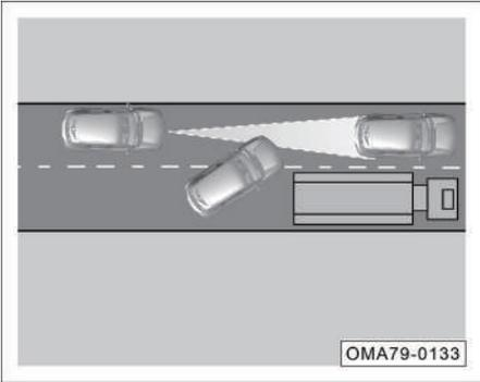
5. Cuando otros vehículos cambian de carril. Cuando un vehículo en un carril adyacente entra a su carril, si el vehículo no se encuentra en el rango de detección, el sensor de radar puede no detectar el vehículo, lo que resulta en una respuesta demorada del ACC.
