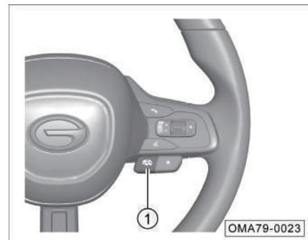
Método I: A través del interruptor de botón de sonido de escape ① en el lado derecho del volante, puede elegir activar o desactivar el sonido de escape según los diferentes modos de conducción.
