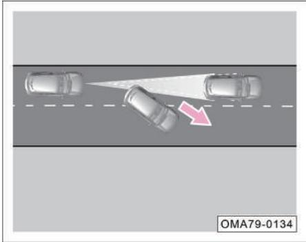
6. El vehículo objetivo que iba delante se corta repentinamente o aparece un vehículo detenido a corta distancia. La respuesta del sensor de radar y el actuador del freno será demorada, y la respuesta del freno no será oportuna.
