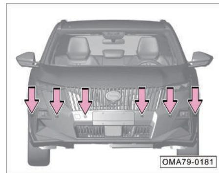
El sensor de radar está montado en la cubierta del parachoques delantero (para los modelos de radar delantero y trasero).
