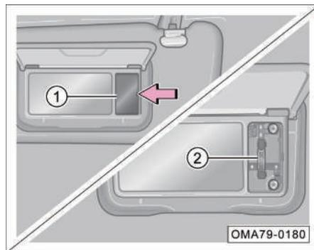
1. Haga palanca con cuidado para extraer la tapa de la luz del espejo de cortesía ① a lo largo de la posición -flecha-.
