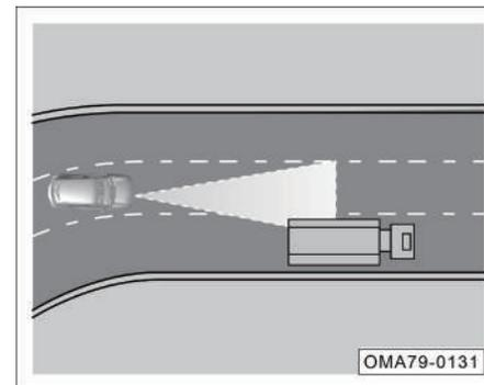
3. Salir de la curva. Al salir de una curva larga, debido a que el sistema calculará previamente el carril de conducción, el sensor de radar puede reaccionar al vehículo en el carril adyacente y frenar el vehículo. Este proceso de frenado se puede interrumpir presionando el pedal del acelerador.
