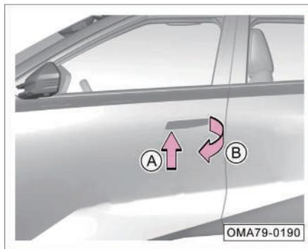
Cuando la "Manija de puerta eléctrica oculta" está desactivada, la manija de puerta debe desplegarse manualmente. Desbloquee todo el vehículo, presione el lado izquierdo de la manija de puerta en la dirección de la -flecha A- para que se levante el lado derecho de la manija de puerta, luego tire de la manija de puerta en la dirección de -flecha B- para abrir la puerta. Después de soltar la manija de puerta, la manija de puerta volverá automáticamente a la posición oculta.
