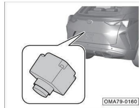
La cámara trasera queda instalada al lado de la luz de matrícula.
