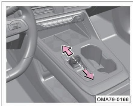
La palanca de cambios tiene las marchas "P, R, N, D, S". Cuando la alimentación del vehículo está en la posición "ON", el instrumento combinado muestra la información de la marcha correspondiente después de cambiar de marcha.
