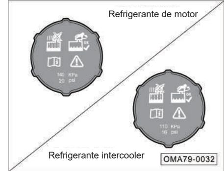
Después de comprobar el nivel de refrigerante, si necesita agregar refrigerante, siga los pasos a continuación:
