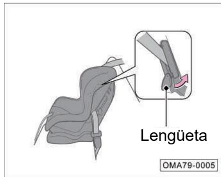
5. Coloque correctamente el cinturón de seguridad y empuje la lengüeta hacia arriba. Asegúrese de que el cinturón de seguridad no esté torcido. Al empujar la lengüeta hacia arriba, tire la parte superior del cinturón de seguridad del hombro hacia arriba, para que el cinturón de seguridad no esté suelto.
