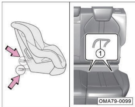
1. Coloque silla de seguridad infantil en el asiento, busque el punto de fijación delantero ① e inserte la ranura de guía de instalación inferior-flecha de la silla de seguridad infantil en el punto de fijación delantero ① hasta que escuche un clic.
