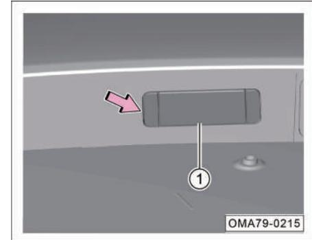
1. Haga palanca en el conjunto de la luz de la placa de matrícula ① en la dirección de la -flecha-.
