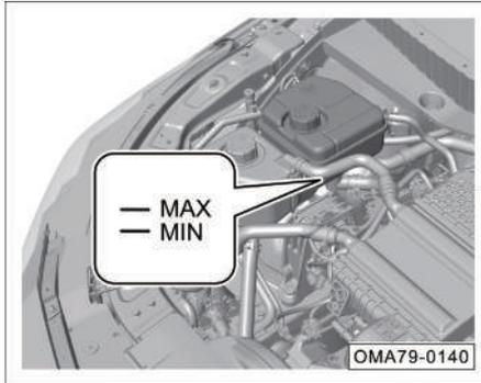
Compruebe que el nivel de refrigerante en el tanque de expansión de refrigerante del motor esté entre la marca de límite superior "MAX" y la marca de límite inferior "MIN".
