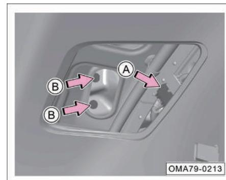
3. Desconecte el enchufe de conexión de la luz combinada trasera - flecha A-.
