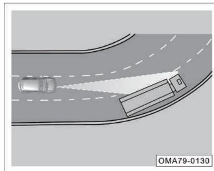
2. Conducir a través de la curva. Es posible que el sensor de radar no pueda capturar el vehículo adelante ni reaccionar al vehículo en el carril adyacente al conducir por una curva. En este caso, el ACC puede frenar el vehículo, reducir la velocidad del vehículo o no responder al vehículo de delante, pisar el pedal de freno o cancelar el ACC manualmente para salir del sistema ACC.
