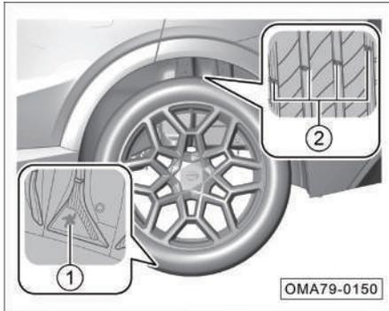
El icono ① se utiliza para indicar el desgaste de la banda de rodadura exterior del neumático. Si el rayado de banda de rodadura exterior del neumático se desgasta en el patrón, el neumático ya no es seguro de usar y debe reemplazarse inmediatamente.
