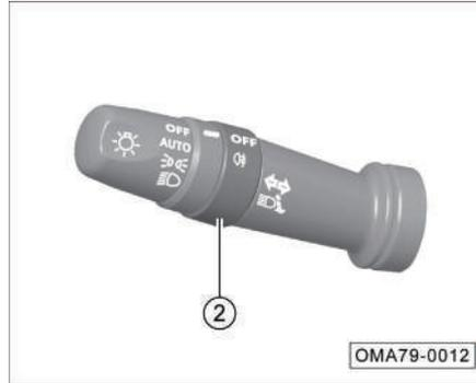
Cuando la alimentación del vehículo está en la posición "ON", y la luz de cruce está encendida, gire el interruptor de la luz antiniebla ② para encender o apagar
