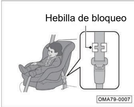
Si la silla de seguridad infantil no tiene el dispositivo para fijar el cinturón de seguridad, monte una hebilla de bloqueo en el cinturón de seguridad.
