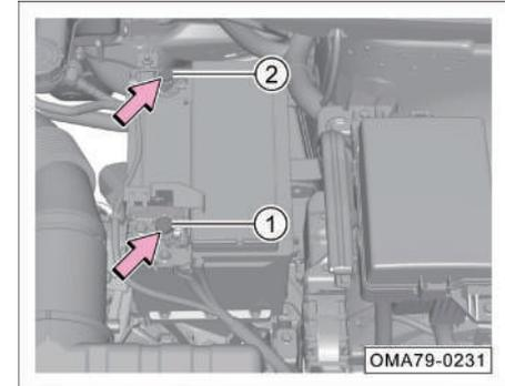
2. Conecte el clip del cable de puente positivo rojo al polo positivo de la batería del vehículo (1), y el clip en el otro extremo se conecta al polo positivo de la batería de otro vehículo; Conecte el clip del cable de puente negativo negro al polo negativo (2) de la batería del vehículo y conecte el clip del otro extremo al bloque del motor o una pieza de metal firmemente conectada al bloque del motor de otro vehículo.
