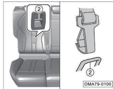
2. Pase la correa de sujeción por la parte superior del respaldo, localice el punto de fijación trasero ② y enganche el gancho de la correa de sujeción en el punto de fijación trasero ② para asegurarse de que la correa no esté torcida.
