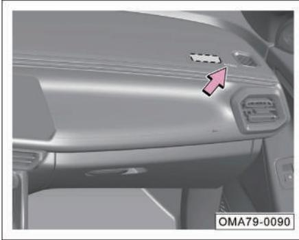
El airbag frontal del pasajero delantero está montado en el interior del tablero de instrumentos (zona sombreada con línea discontinua) con el símbolo "AIRBAG".
