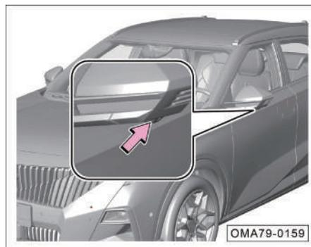
Las cámaras izquierda/derecha quedan instaladas respectivamente de los retrovisores exteriores izquierdo/derecho.
