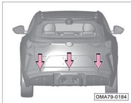
El sensor de radar está montado en la cubierta del parachoques trasero (para los modelos de radar trasero).
