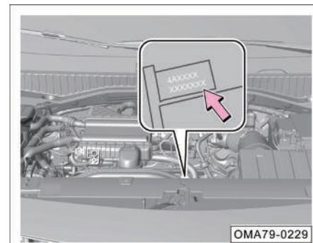
Modelo de motor y número de fábrica - flecha - situado en el bloque del motor (por encima del arrancador).
