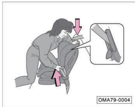
4. Sostenga el cinturón de seguridad del hombro cerca de la hebilla, tire hacia arriba para que el cinturón de seguridad de la cintura no esté suelto. En este momento, presione sobre la silla de seguridad infantil con su propio peso y empújelo hacia el asiento del vehículo.
