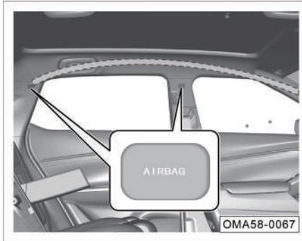
El airbag lateral de tipo de cortina está montado en el interior de la parte izquierda y derecha del techo (parte sombreado por línea de puntos), y "AIRBAG" es el símbolo del airbag.
