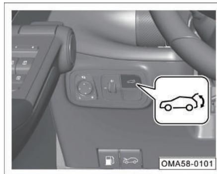
Mantenga presionado el botón del portón trasero en el tablero de instrumentos para desbloquear el portón trasero.
