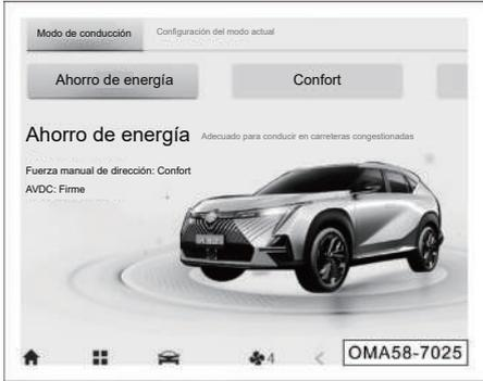
3. Con la alimentación del vehículo en posición "ON", seleccione para cambiar el modo de conducción a través del menú de la aplicación del sistema de audio "AVDC→ Modo de conducción".
