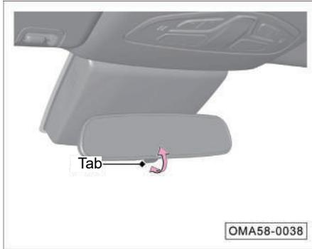
El ajuste manual del espejo retrovisor interior puede debilitar los reflejos procedentes de la parte trasera y permite que el campo de visión trasera esté en condiciones óptimas.
