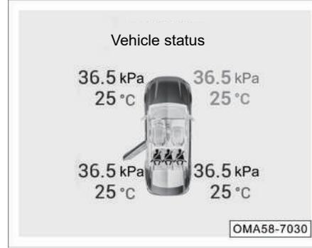
Cuando la alimentación de vehículo está en la posición "ON", gire hacia arriba/abajo el botón "OK" situado en el lado izquierdo del volante para ver el estado del vehículo.
