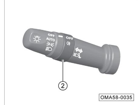
Cuando la alimentación del vehículo está en la posición "ON", y la luz de cruce está encendida, gire el interruptor de la luz antiniebla ② para encender o apagar
