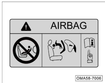
En la parte delantera y trasera de la visera derecha hay una señal de advertencia para alertar de los peligros de los airbags frontales para el pasajero de la fila delantera. Lea y siga las instrucciones en las señales.
