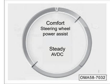
Cuando la alimentación de vehículo está en la posición "ON", el modo AVDC se puede verificar girando el botón "OK" en el lado izquierdo del volante hacia arriba/abajo.
