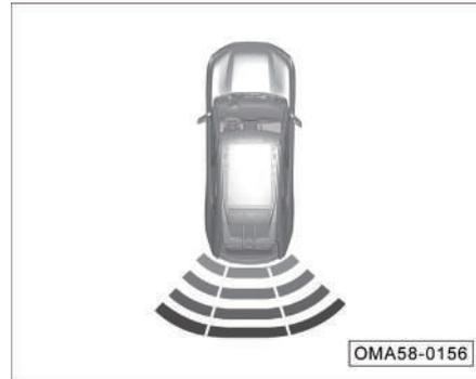
El icono esquemático dinámico que aparece en la pantalla indica la distancia entre el vehículo actual y el obstáculo. La capa más externa del vehículo en la imagen es una línea verde, y gradualmente se convierte en una línea amarilla, una línea naranja y una línea roja hacia adentro. Cuando el obstáculo se acerca al vehículo, la línea de color cambiará gradualmente de la capa más externa a la capa interna.
