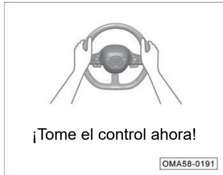
Cuando el sistema de abandono de carril detecta que las manos del conductor están fuera del volante durante mucho tiempo, el sistema emitirá un aviso de toma de control y el instrumento combinado mostrará la imagen antedicho y estará acompañado por un sonido de alarma. Este aviso solo existe cuando el conductor selecciona "Dirección", "Dirección y Advertencia".
