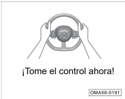
Cuando ICA detecta que las manos del conductor están fuera del volante durante mucho tiempo, el sistema emitirá un aviso de toma de control, y el instrumento combinado mostrará la figura anterior y sonará el zumbador.
