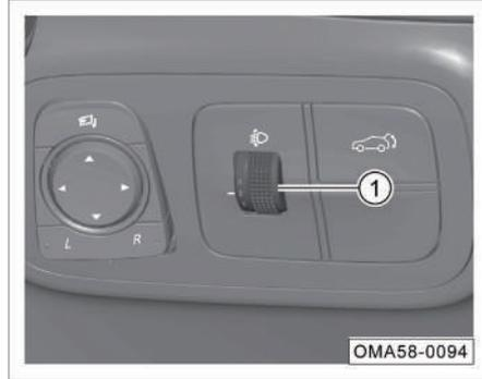
Gire la perilla ① para ajustar manualmente el rango de iluminación de los faros (luz de cruce), y las posiciones de ajuste son "0, 1, 2, 3". La altura de la luz disminuirá a medida que aumente el valor de ajuste.
