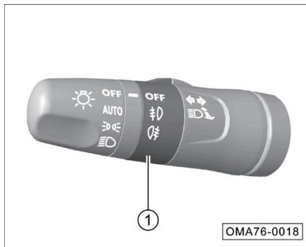
Cuando el interruptor de encendido está en la posición "ON" y la luz de posición o la luz de cruce está encendida, gire el interruptor de la luz antiniebla ① para encender o apagar  $\text{☞D}$  (la luz antiniebla delantera) y  $\text{☞E}$  (la luz antiniebla trasera).
