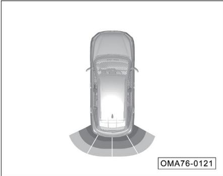
El icono dinámico en la pantalla indica la distancia entre la parte delantera y trasera del vehículo y el obstáculo. En la figura, la capa más externa del vehículo es una línea amarilla y el interior se convierte gradualmente en una línea naranja y una línea roja. Según el intervalo del valor de la señal de distancia del sensor del sistema de radar, se muestra la barra de radar de color correspondiente y no se muestran otras barras de radar.
