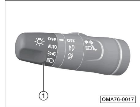
Cuando el interruptor de encendido está en la posición "ON", gire el interruptor de luces ① para controlar el encendido o el apagado de  $\text{DQ}$  (la luz de posición) y  $\text{DQ}$  (la luz de cruce).
