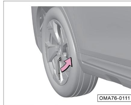
Coloque la llave de desmontaje del perno de la rueda firmemente en el perno de la rueda y afloje los pernos de la rueda en sentido contrario a las agujas del reloj.
