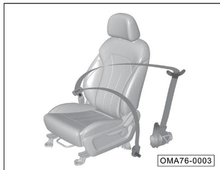
Cuando se produce una colisión entre vehículos, el uso correcto del cinturón de seguridad puede sujetar al conductor y a los pasajeros en una posición adecuada, reducir la inercia del conductor y de los pasajeros, evitando que el conductor y los pasajeros sean arrojados hacia adelante, al mismo tiempo, permitiendo que el conductor y los pasajeros obtienen una mejor protección proveniente de airbags, y así, se puede minimizar las lesiones por impacto.
