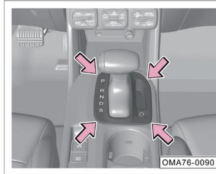
Cuando la palanca de cambios está bloqueada y no se puede salir de la marcha "P" normalmente, se debe liberar el bloqueo de la palanca de cambios.
