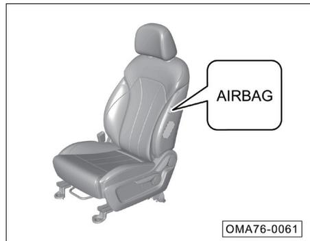
El airbag lateral de la fila delantera está instalado en el interior del respaldo del asiento del conductor y del asiento del pasajero, que está cerca de la puerta (parte sombreada por línea de puntos), y "AIRBAG" es el símbolo del airbag.
